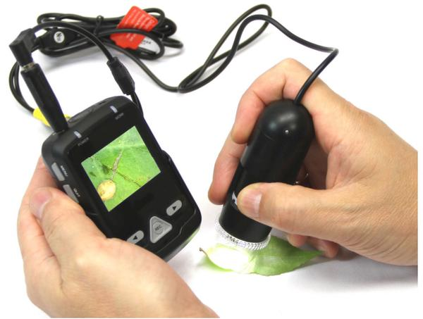
Die ultimative Lösung für mobile Mikroskopie, eine Kombination eines Dino-Lite Digitalmikroskops mit Polarisator und eines mobilen Digitalrekorders mit 2-Zoll LCD-Bildschirm.
